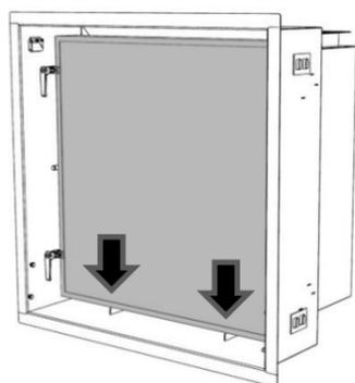
Luftfilter auf Stützschienen aufsetzen.
